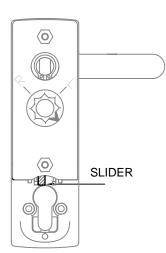
LOOKING AT THE LOCK FROM THE REAR, MOVE THE SLIDER TO THE LEFT
